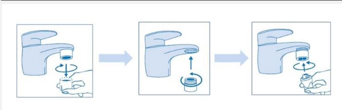
1 – Retirar o filtro da torneira e substituir pelo filtro adaptador de Sowash.
